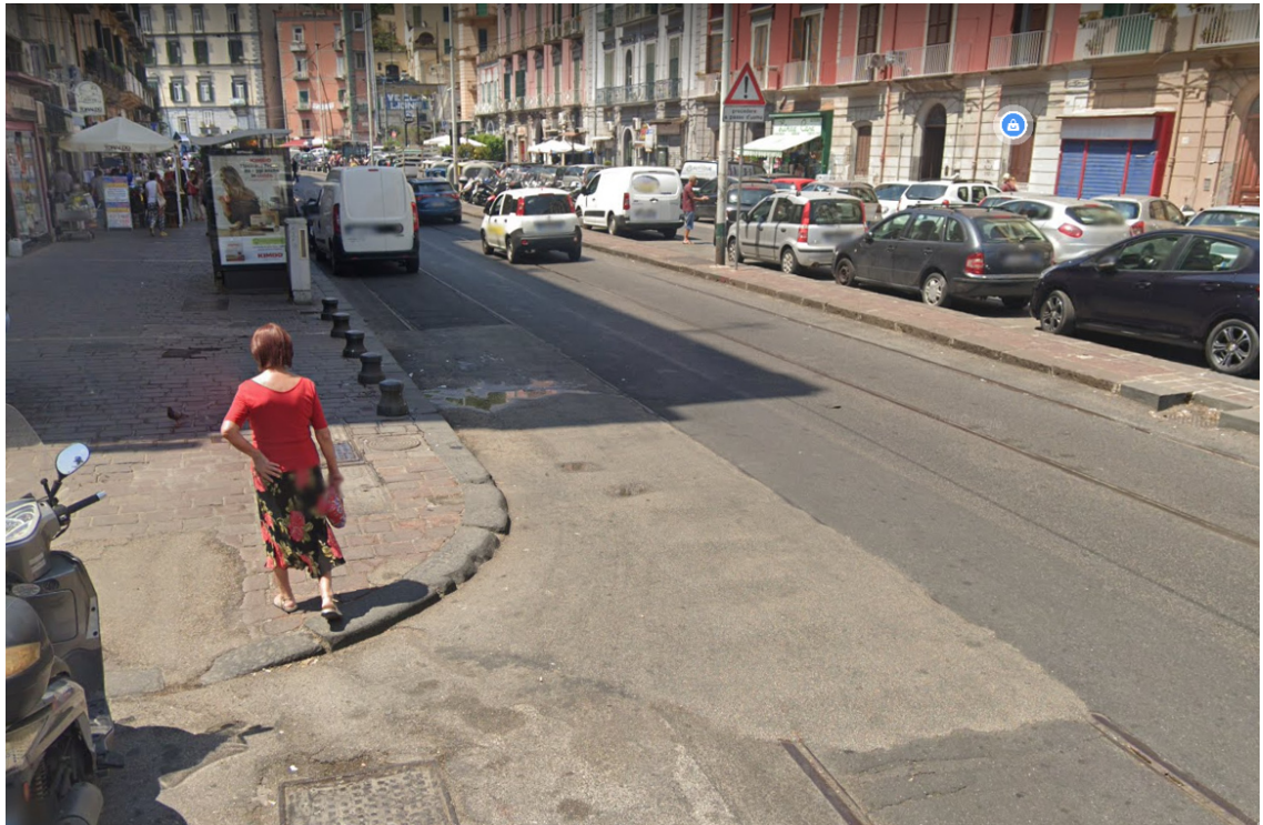
Via Giordano Bruno: si evince la copertura di alcuni tratti della sede tranviaria con conglomerato bituminoso con evidenti dissesti alle traverse che costituiscono l'armamento
