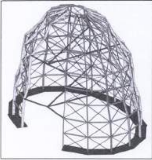
SCHEMA TRIDIMENSIONALE DI MONTAGGIO A SPICCHI (senza controventi)
