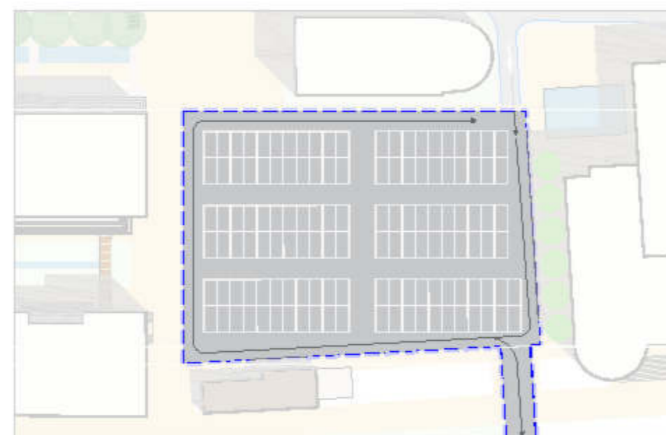
Schema PK6 Parcheggio interrato n.1 piano interrato sup: 3089 mq posti auto: 123
