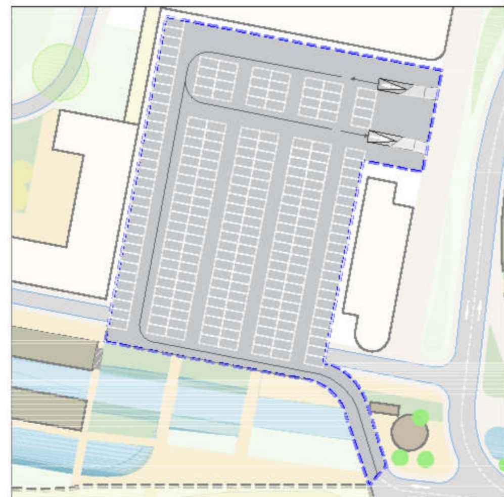
Schema PK1 Parcheggio interrato n.1 piano interrato sup: 5519 mq posti auto: 220
