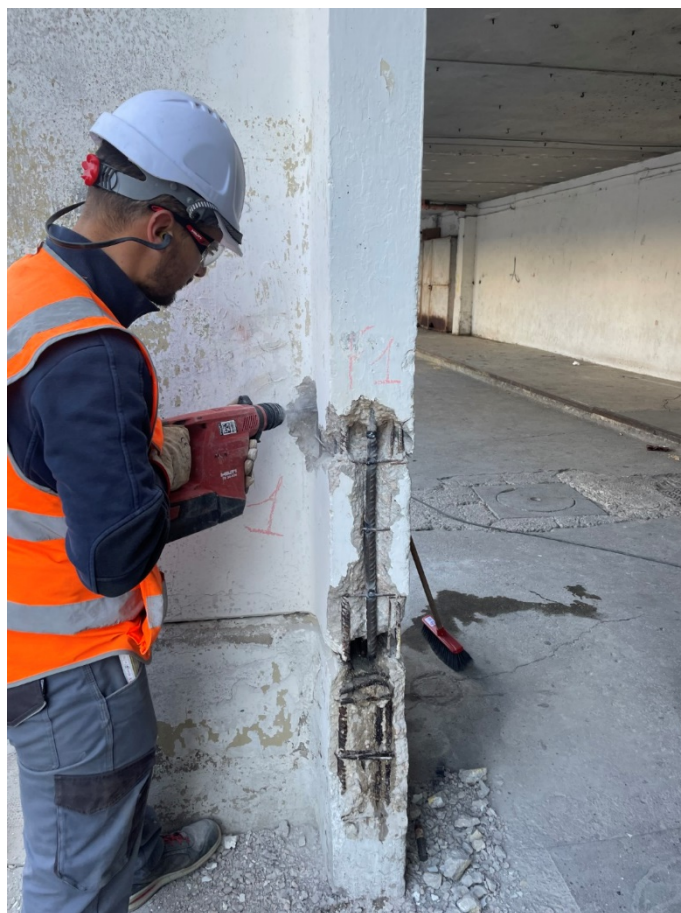
Fotografia 7 Esecuzione di un saggio a breccia
