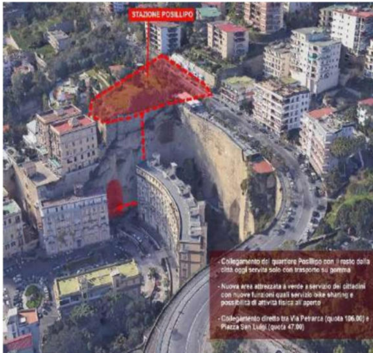
Schema collegamento Piazza Tecchio-Via Petrarca mediante ascensore
