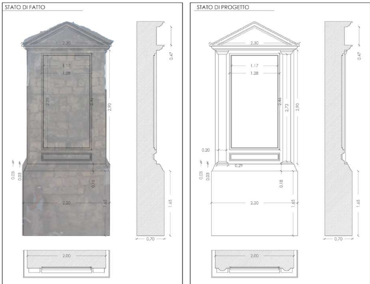
Restauro dell'edicola votiva compresa nel perimetro d'intervento
