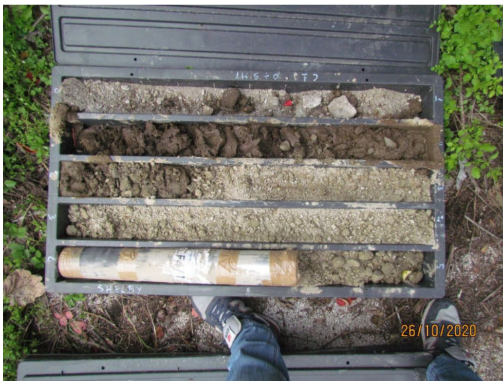
cassetta catalogatrice 0 – 5 m con fustella campione prelevato a 4 m
