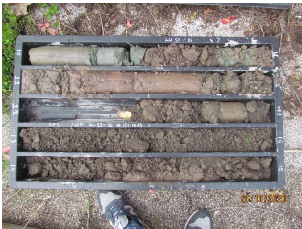
cassetta catalogatrice 10 -15m con SPT a 12 m
