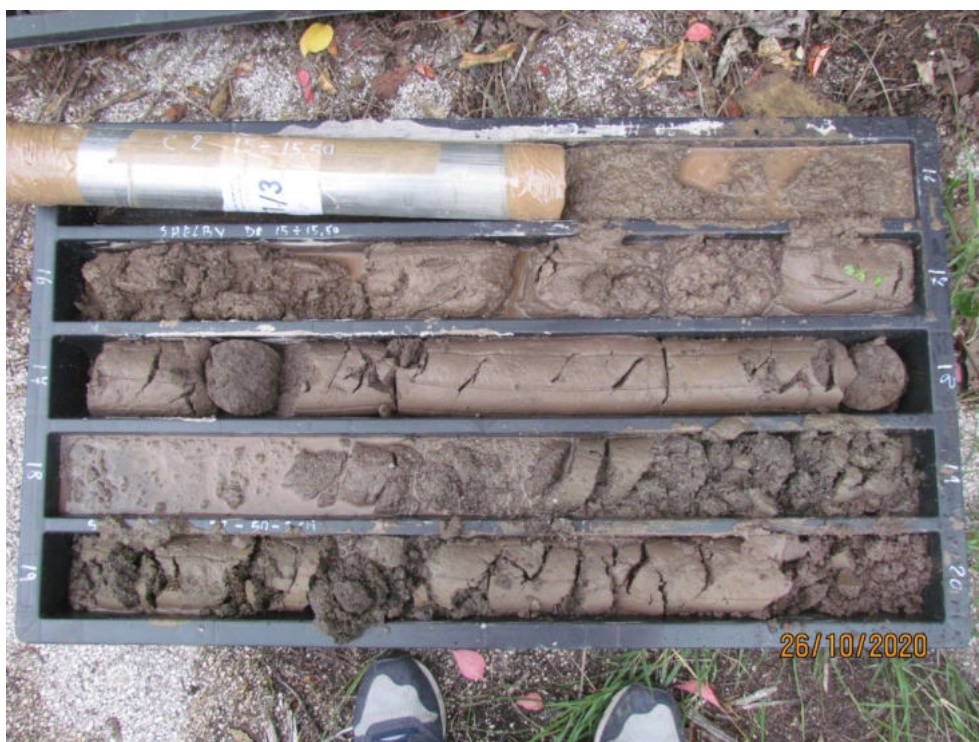
cassetta catalogatrice 15 -20 m con fustella campione prelevato a 15 m ed SPT eseguito a 18 m
