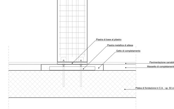
**DETTAGLIO NODO TRAVE PREFABBRICATA - PILASTRO PREFABBRICATO A SEZIONE OVALE 33\*55 cm**
