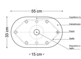
**DETTAGLIO ATTACCO A TERRA PILASTRO PREFABBRICATO A SEZIONE OVALE 33\*55 cm**
