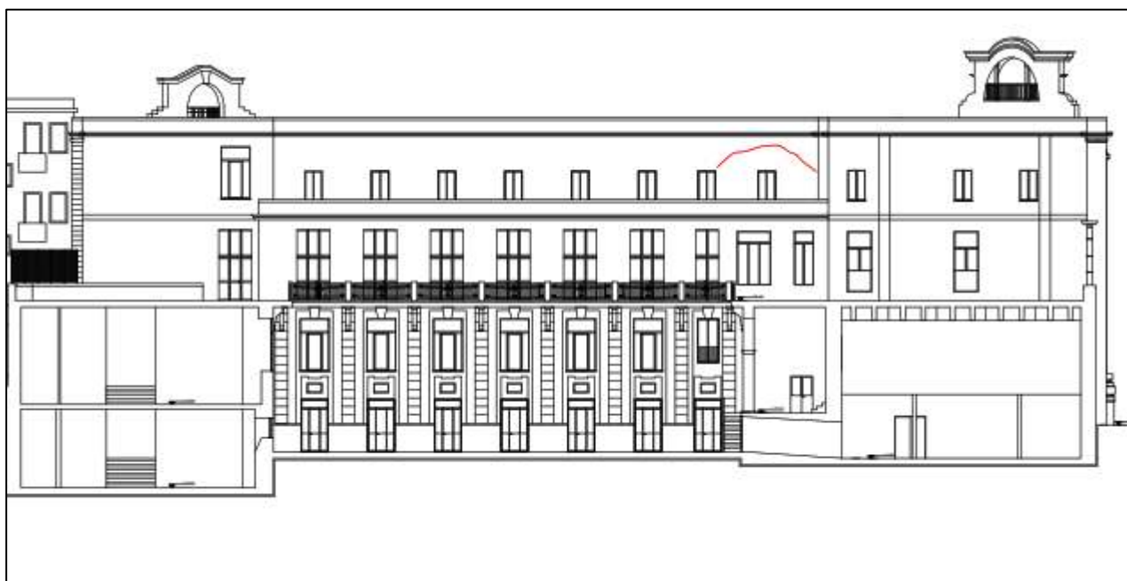
Fig.16: Quadro fessurativo Sezione A-A Stato di Fatto.
