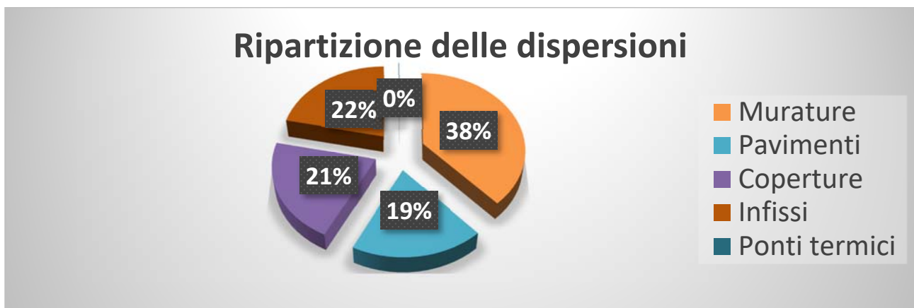
Incidenza dispersioni dei componenti involucro
