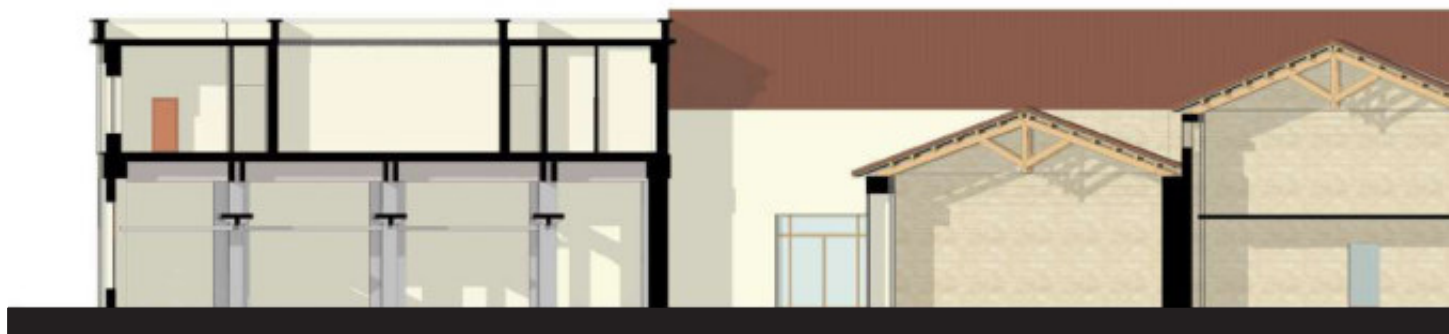
Figura 33 - Sezioni di confronto dei modelli informativi BIM tra il rilievo eseguito dal gruppo di ricerca e il Progetto preliminare approvato nel 2014
