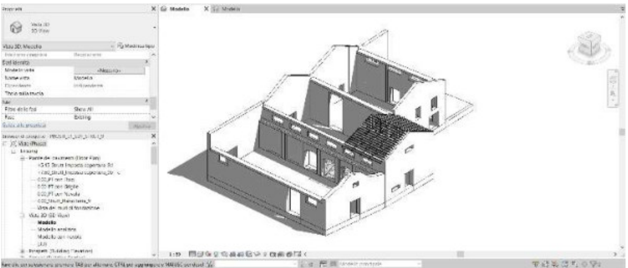
Figura 27 - Integrazione dei modelli disciplinari distinti (architettonico e strutturale).
