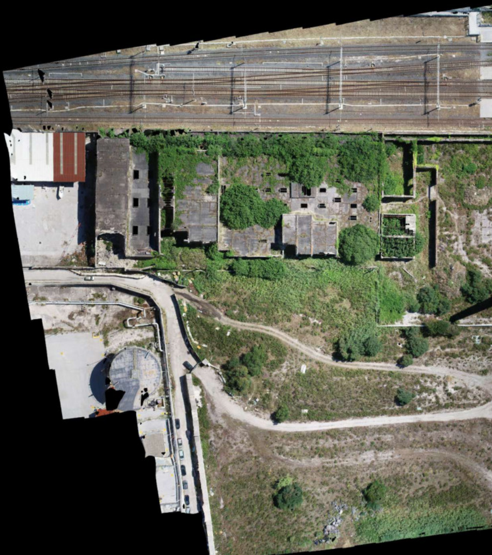
Figura 24 - Immagine dall'alto della nuvola di punti ottenuta dal rilievo fotogrammetrico.
