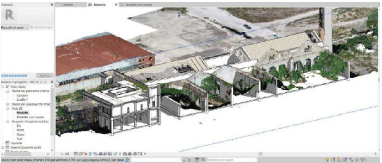
Figura 26 - Sovrapposizione geometrica tra modello e nuvola di punti.
