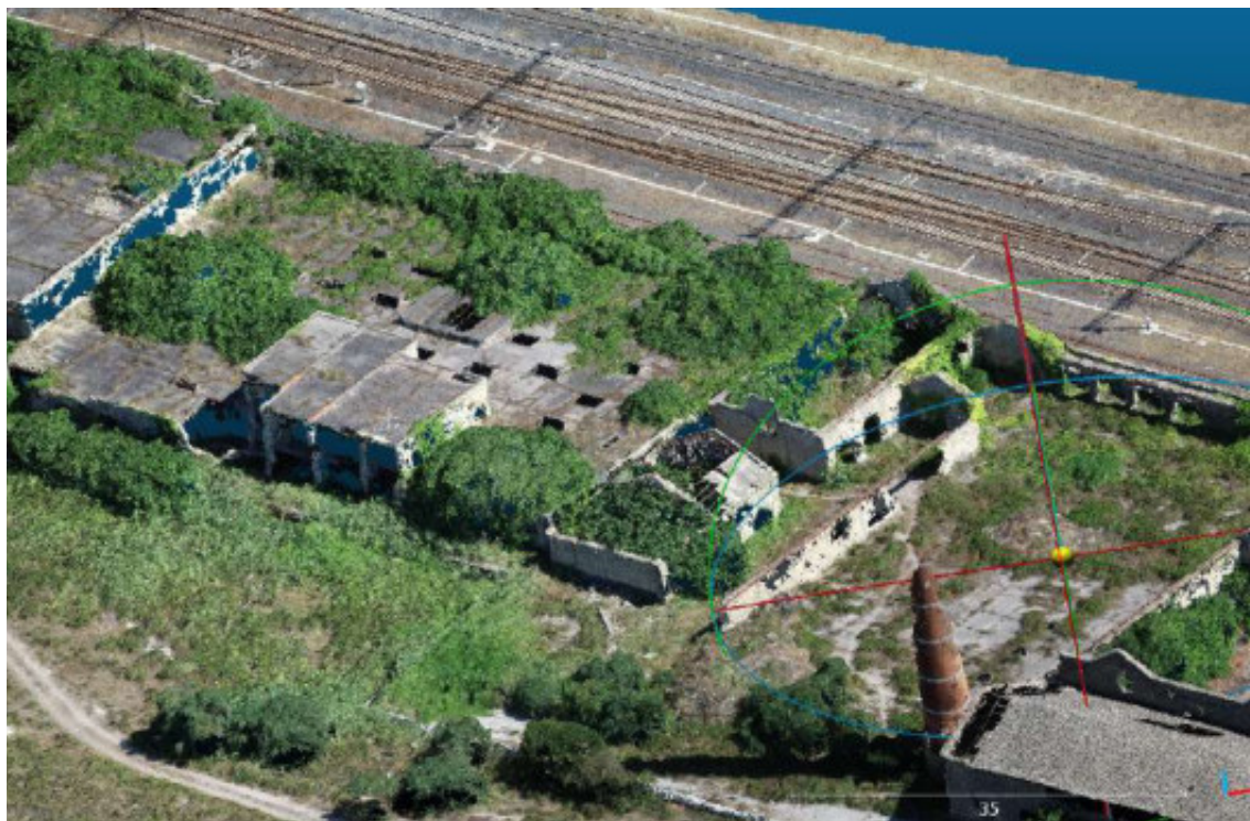
Figura 23 - Ricostruzione della nuvola di punti a partire dal rilievo fotogrammetrico.
