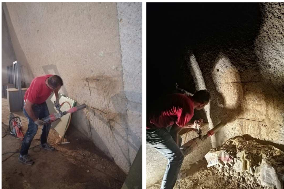
Figura 19. Prelievo del campione C3 in corrispondenza della prova con martinetto piatto M2 (a sinistra) e prelievo del campione C6 in corrispondenza della prova con martinetto piatto M3 (a destra).
