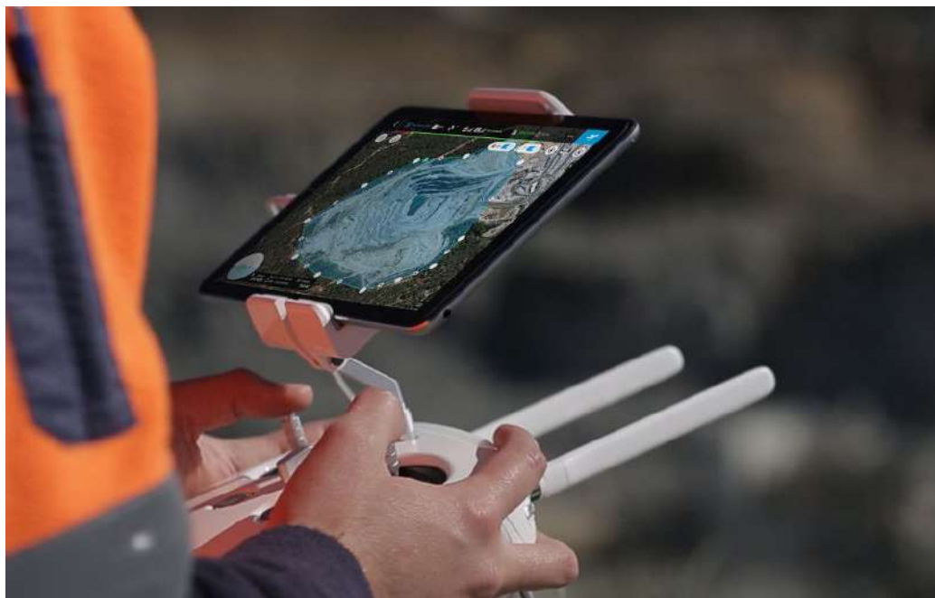
Figura 11: Rilievi 3D di discariche con droni (fonte: propeller aero)
