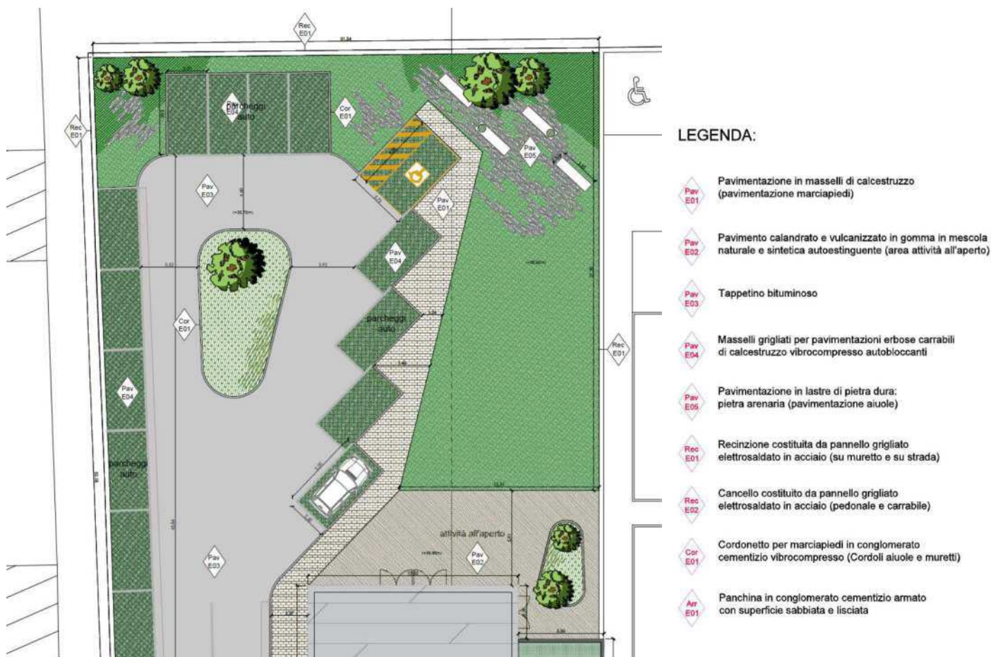
Figura 11 – MATERIALI PREVISTI PER LA SISTEMAZIONE ESTERNA DI PROGETTO
