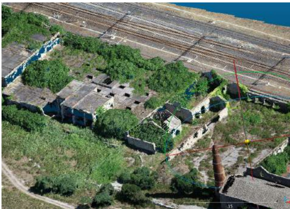
Ricostruzione della nuvola di punti a partire dal rilievo fotogrammetrico.
