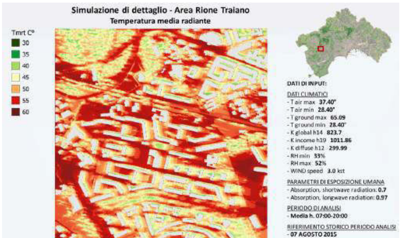
Figura 10. Analisi di dettaglio della Temperature Media Radiante nell'area di Rione Traiano, per una tipica giornata di ondata di calore con temperatura dell'aria di 36-37°C. (Fonte: PLINIVS-LUPT, Progetto CLARITY).
