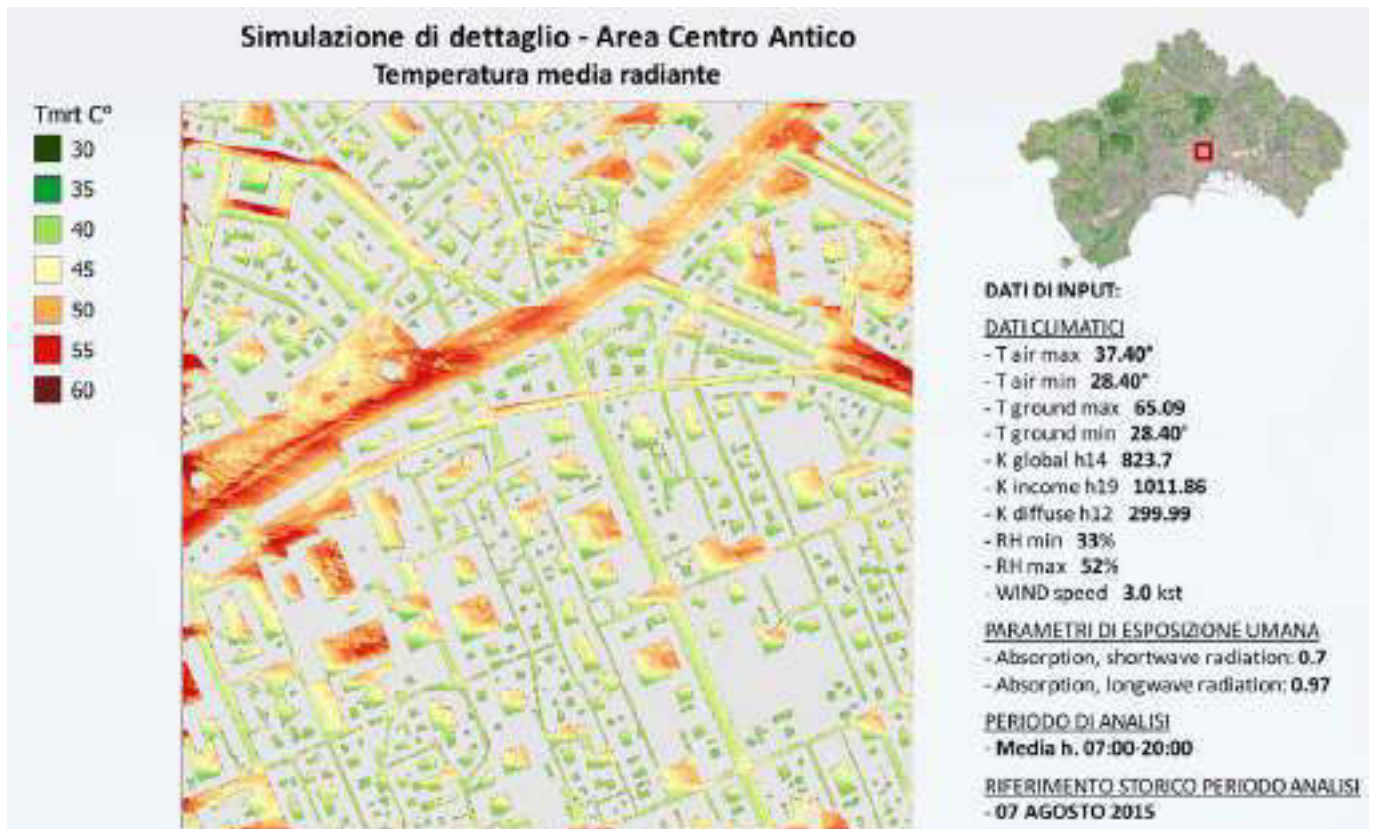
Figura 9. Analisi di dettaglio della Temperature Media Radiante in un'area del centro antico, per una tipica giornata di ondata di calore con temperatura dell'aria di 36-37°C. (Fonte: PLINIVS-LUPT, Progetto CLARITY).
