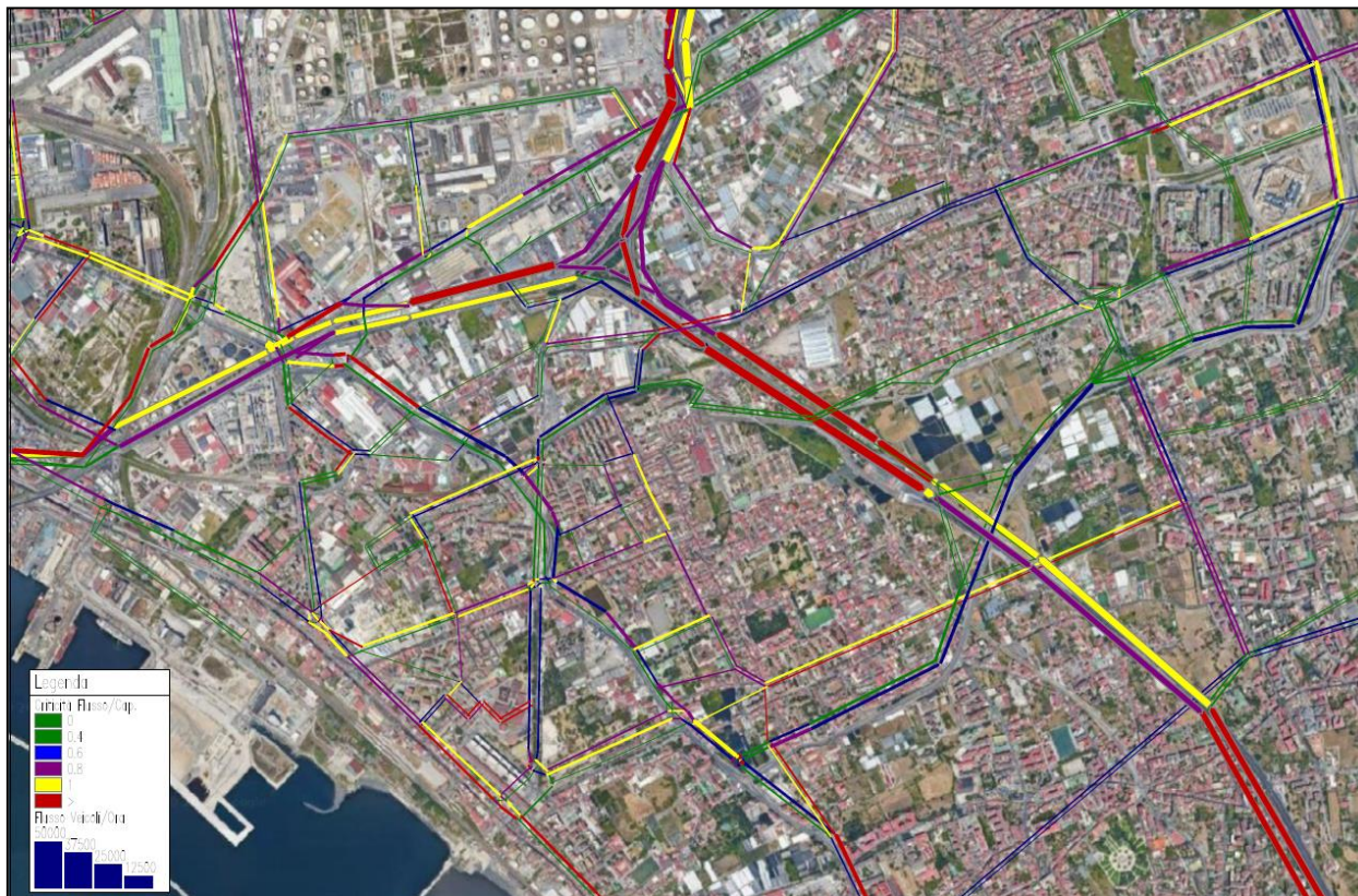
Figura 2.1 – Distribuzione dei flussi e grado di congestione delle strade. Scenario attuale. Ora di punta della mattina feriale.
