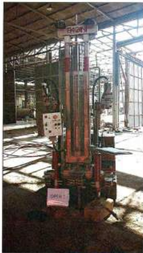
Particolare esecuzione prova DPHS P2
