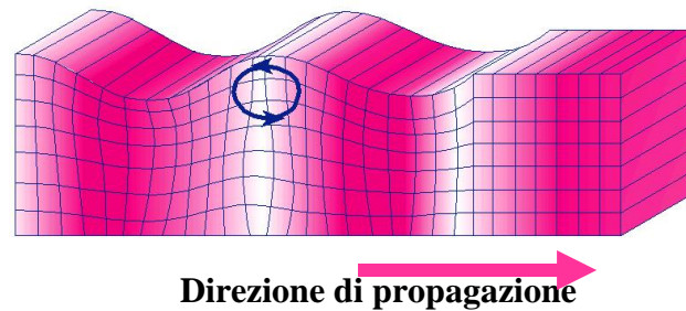
Figura 5 - Rappresentazione grafica della propagazione delle onde superficiali di Rayleigh caratterizzata dall'oscillazione polarizzata in un piano verticale e con movimento delle particelle retrogrado rispetto alla direzione di propagazione dell'onda.
