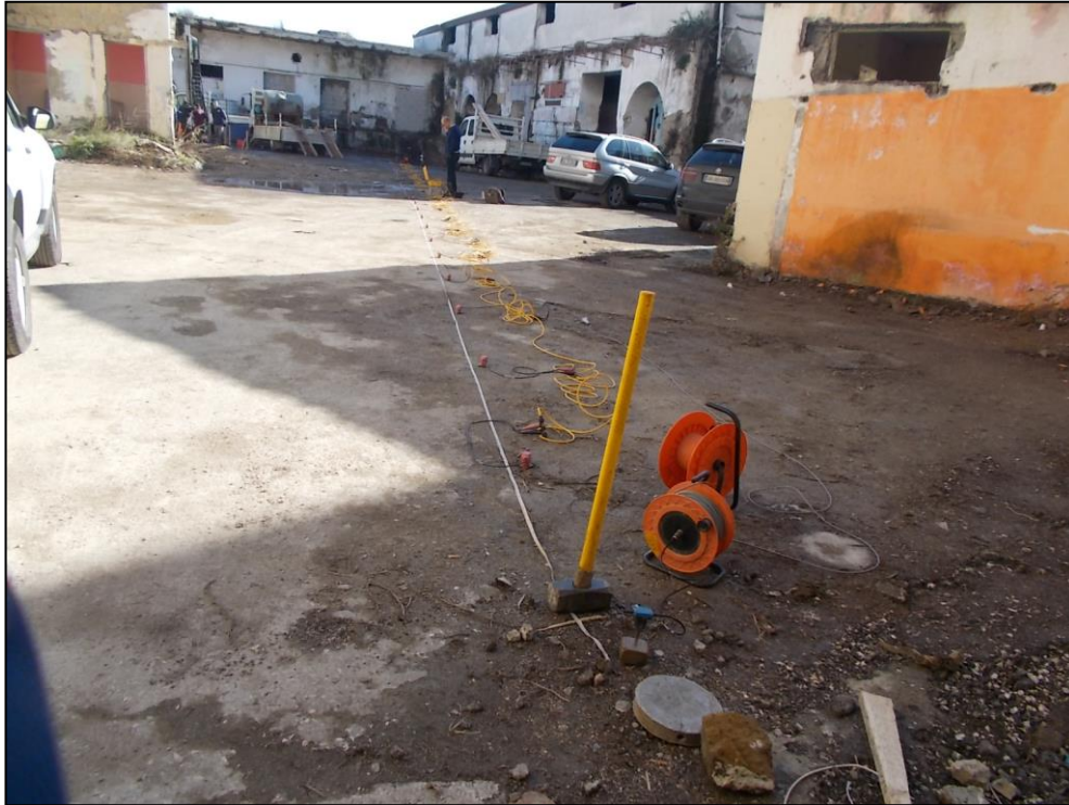
Figura 17 – Sorgente energizzante, costituita da massa battente su piastra di alluminio. Come starter/trigger è stato utilizzato un geofono verticale Geospace a 14Hz.
