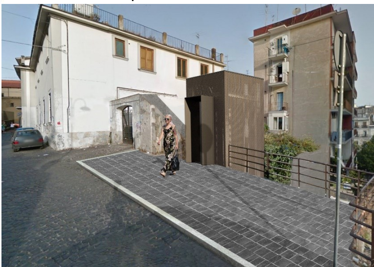
Materiale Lamiera stirata Metaltech in alluminio anodizzato
