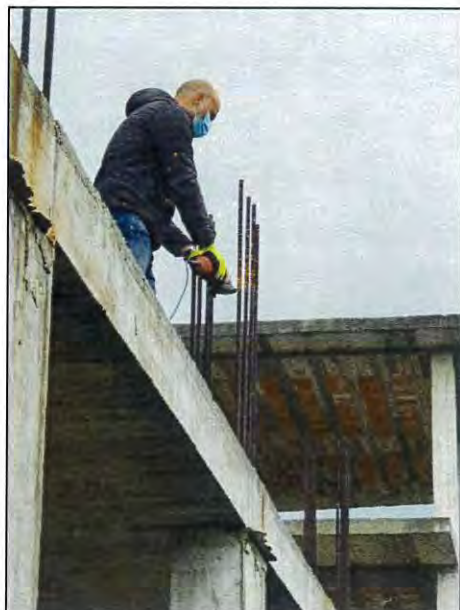
Figura 13: Prelievo campione di armatura PB1
