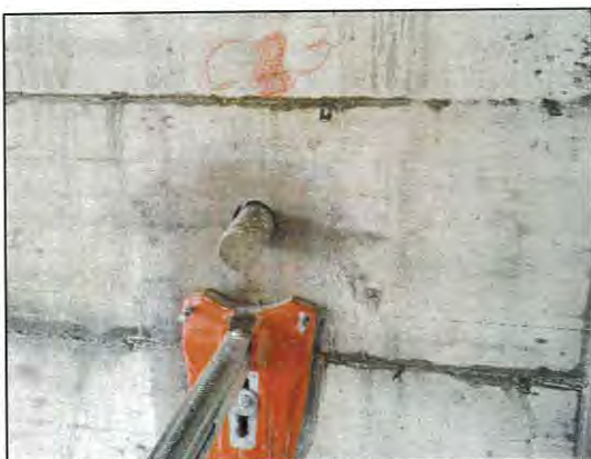
Figura 3: Estrazione carota cls C3
