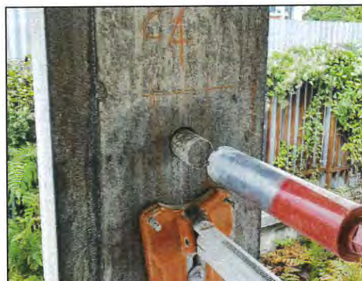
Figura 4: Estrazione carota cls C4
