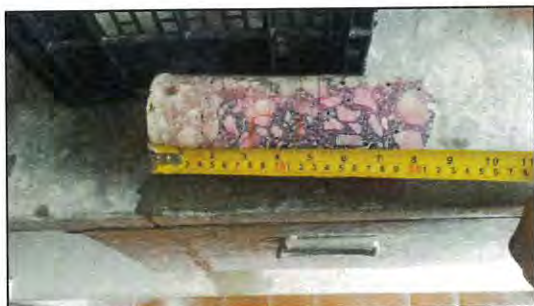
Figura 7: Prova di carbonatazione C1
