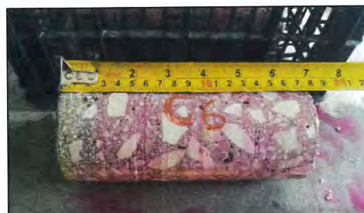
Figura 12: Prova di carbonatazione C6
