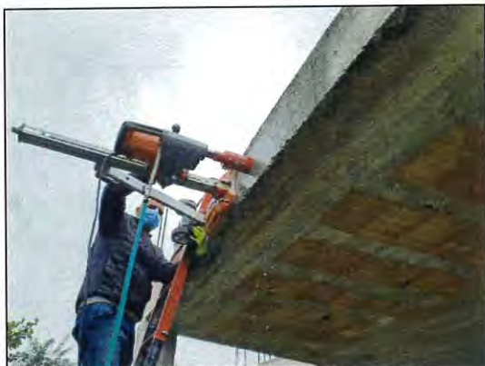
Figura 1: Estrazione carota cls C1
