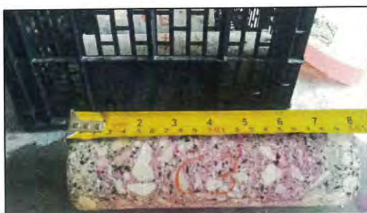
Figura 9: Prova di carbonatazione C3
