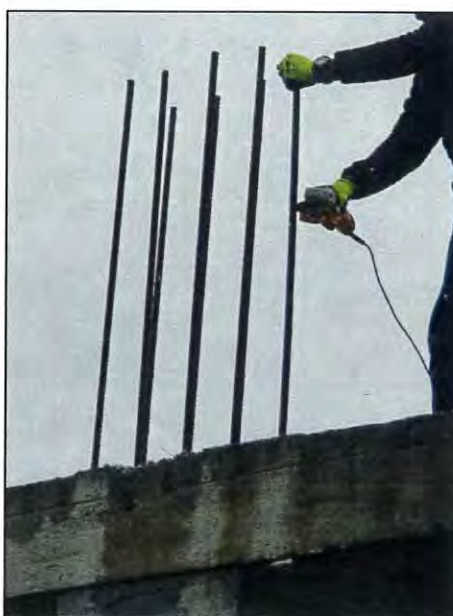
Figura 15: Prelievo campione di armatura PB3
