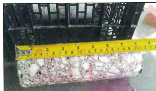
Figura 10: Prova di carbonatazione C4
