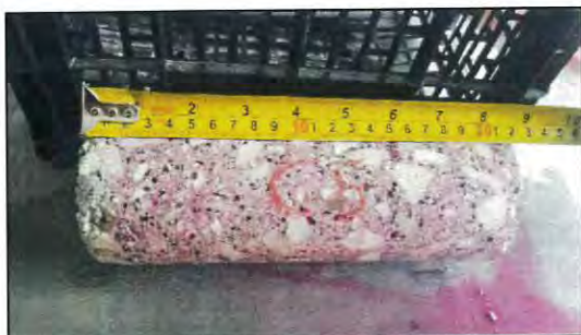
Figura 11: Prova di carbonatazione C5
