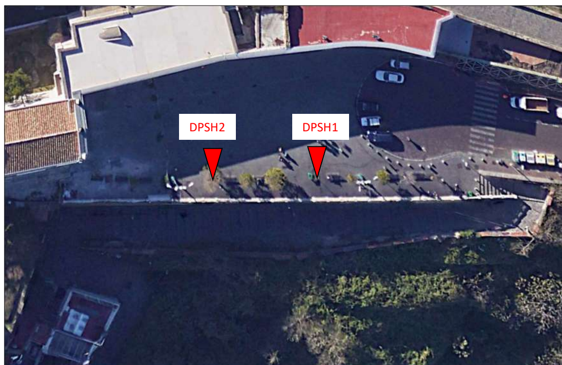
Figura 2: Ubicazione prove penetrometriche DPSH.
