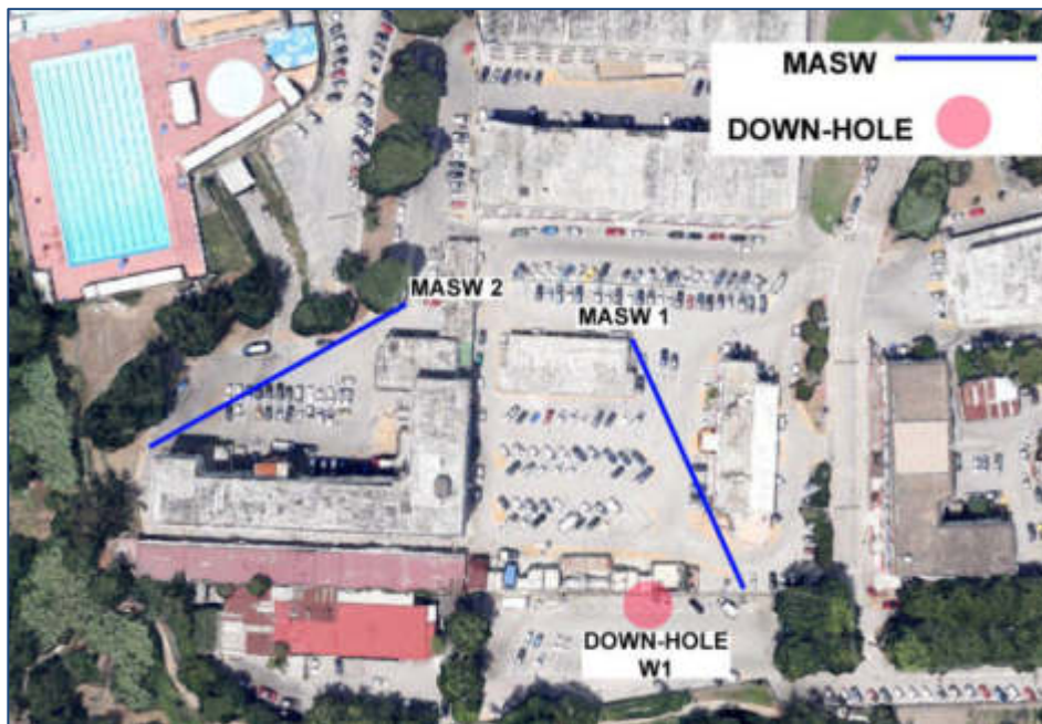
Figura 1 – Ubicazione delle prospezioni sismiche per la caratterizzazione dei terreni intorno al fabbricato E.
