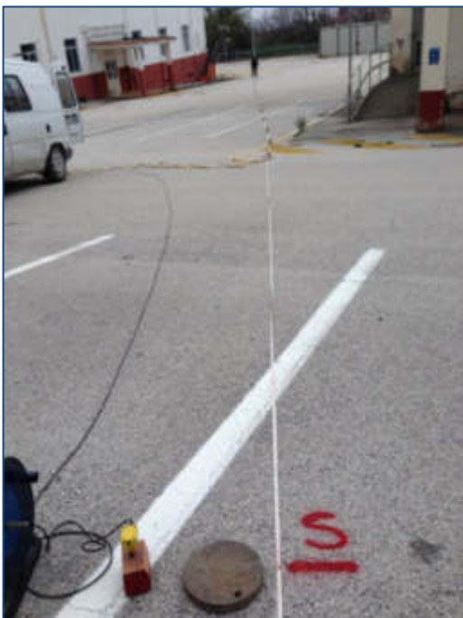
Foto 2 – Prospezione sismica MASW 1. A valle del fabbricato E.
