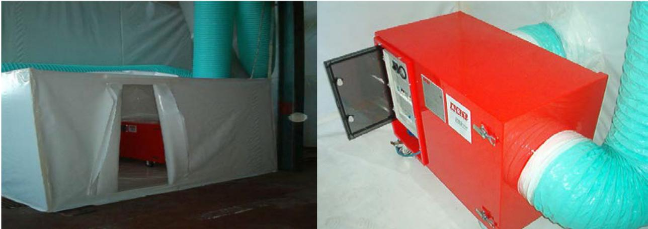
**Figura 4: Sistema di estrazione dell'aria**
