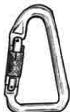
Fig. 23 - Connettore triangolare
