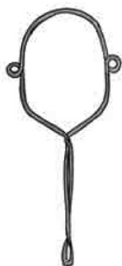
Fig. 25 - Connettore a pinza
