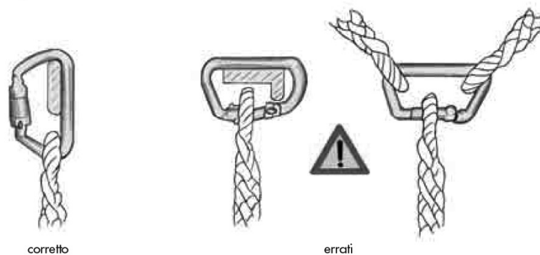
Fig. 42 - Carichi non in asse con la spina
