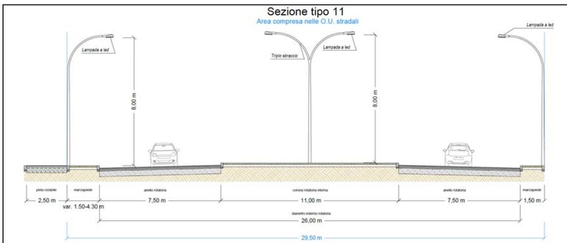
Figura 2.8 - Sezione tipologica asse rotatoria
