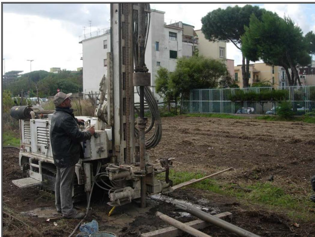
**FOTO N. 7 – Sondaggio n. 3 – Prova SPT**
