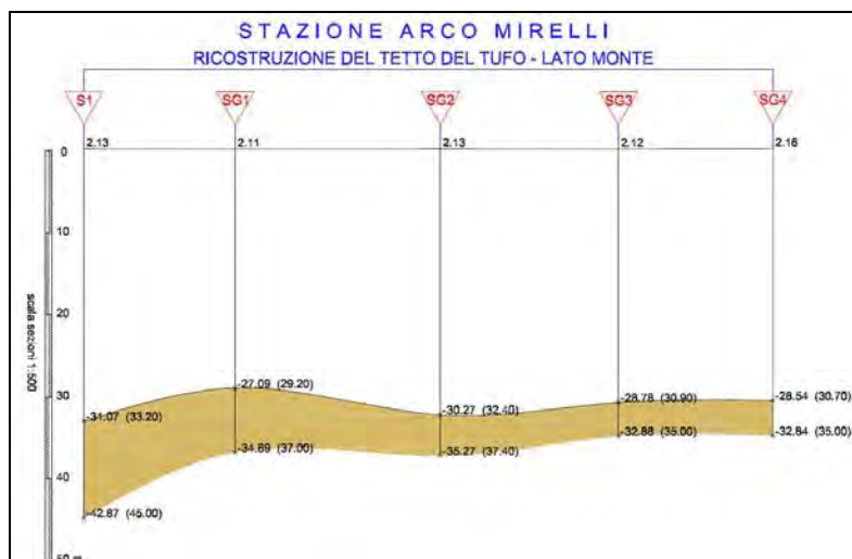
Figura 5.2.: Andamento del tetto del Tufo (lato monte) - Stralcio da Elaborato grafico Progetto Definitivo Stazione Arco Mirelli allegato alla Relazione Geologica (cod. doc.: LM67F2C0157 – ANNO 2005).
