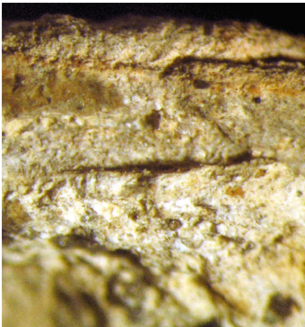
Figura 3 Camp 2 80X Stratigrafia Si osserva uno strato di 1mm di mata finissima per intonaco sovrastante una malta più grossolana
