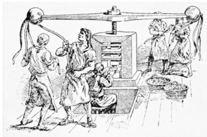
Il bilanciere, una pressa a vite usata per la coniazione di monete e medaglie
