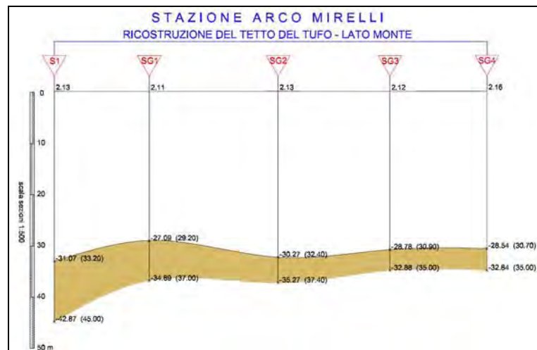
Figura 5.2.: Andamento del tetto del Tufo (lato monte) - Stralcio da Elaborato grafico Progetto Definitivo Stazione Arco Mirelli allegato alla Relazione Geologica (cod. doc.: LM67F2C0157 – ANNO 2005).
