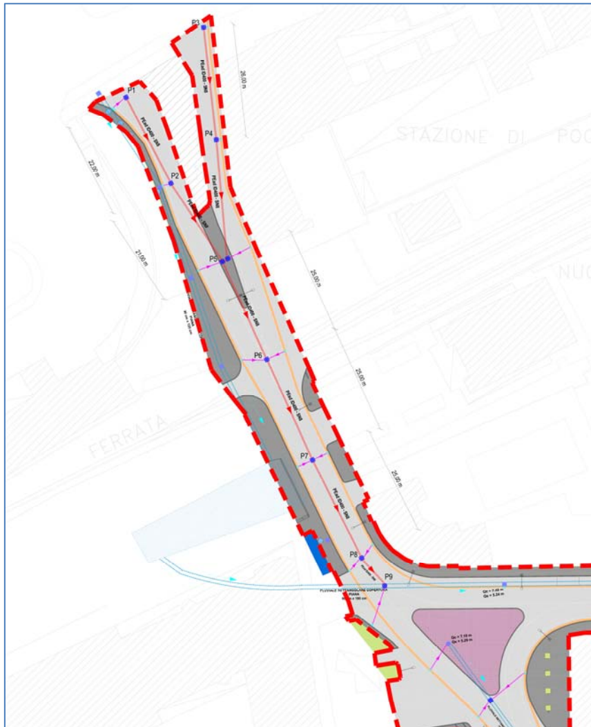
Figura 3.1 - Via Parisi - Rete di smaltimento acque bianche di progetto
