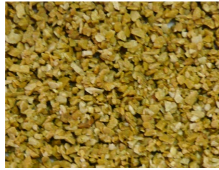
Sentieri interni al Parco: Manto di completamento in inerti colorati (Giallo Mori); spessore 2/3cm.
