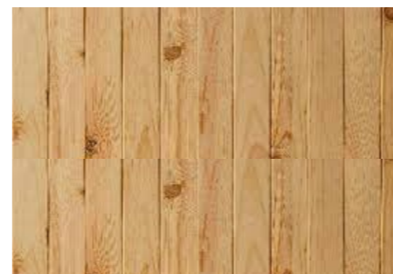
11. Completamento pavimentazione delle piste laterali del Ponte (ciclo-pedonale) Liste in legno massello in Pino Marittimo (H=12cm; Larghezza 4cm; Lunghezza 1,5m) I giunti tra le liste di legno sono in leganti plastici ecocompatibili.
