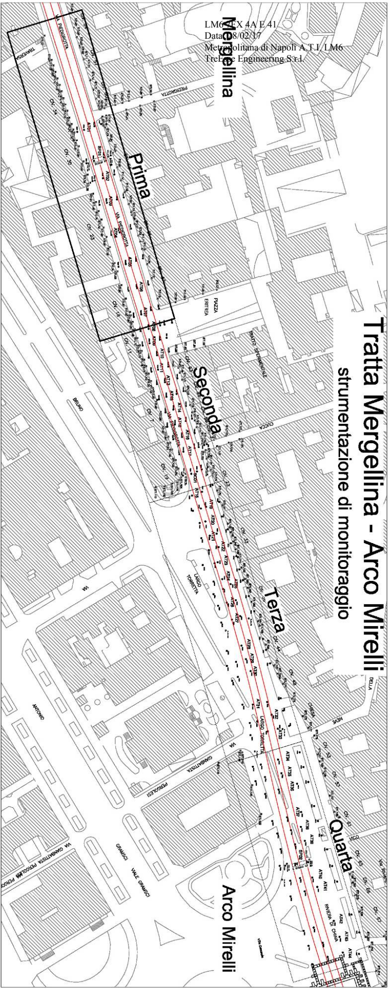
Figura 4.1.: Planimetria tratta Mergellina - Arco Mirelli, raffigurante la disposizione della prima installazione della strumentazione di monitoraggio.
