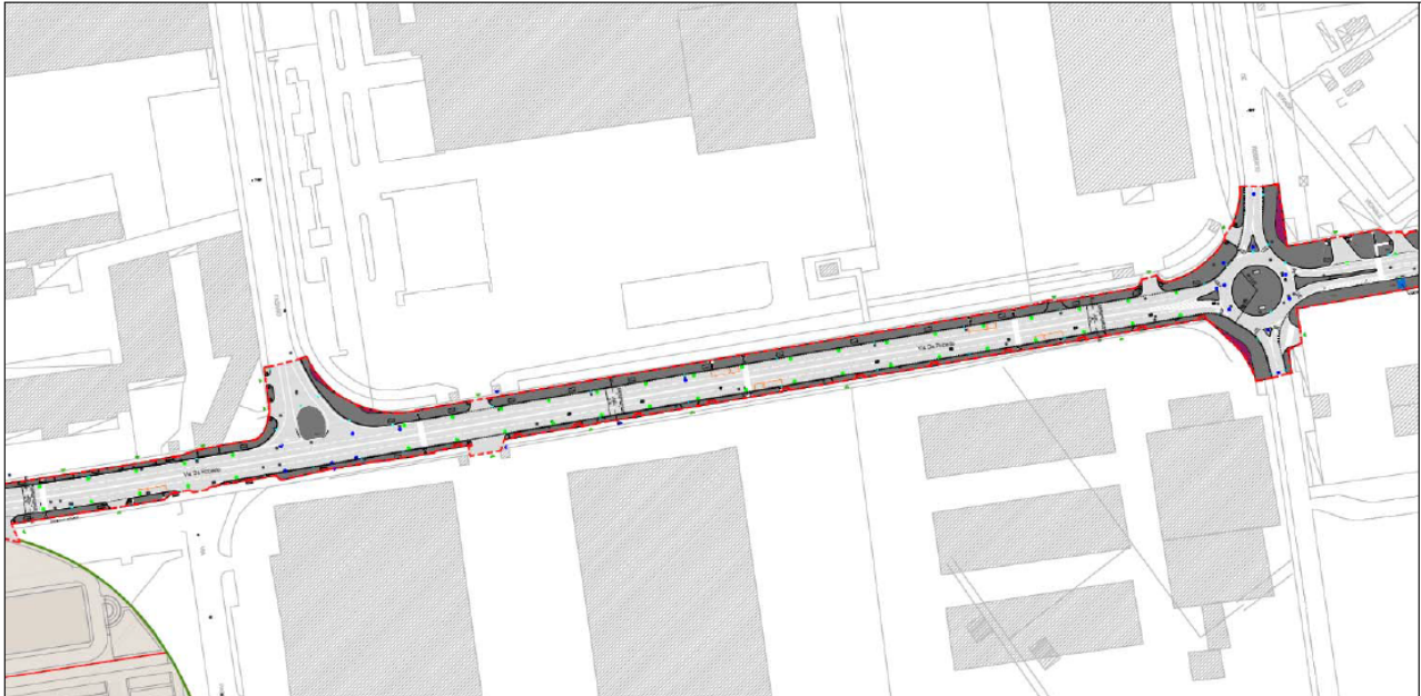
Figura 5.2 - Riconfigurazione dell'intersezioni tra via De Roberto e via Fasano e via De Roberto e Strada Vicinale Galeoncello
