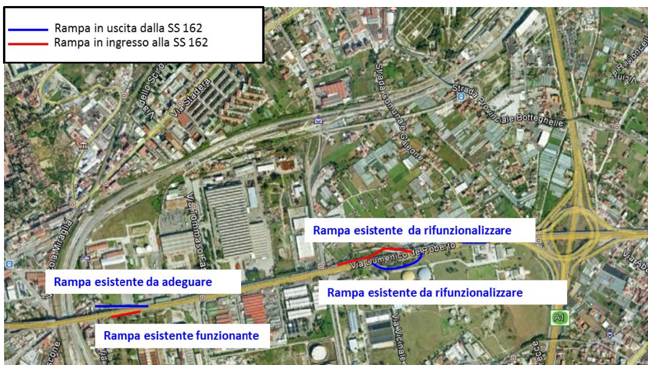
Figura 5.8 - Scenario di progetto- Rampe di collegamento tra via De Roberto e la SS162
