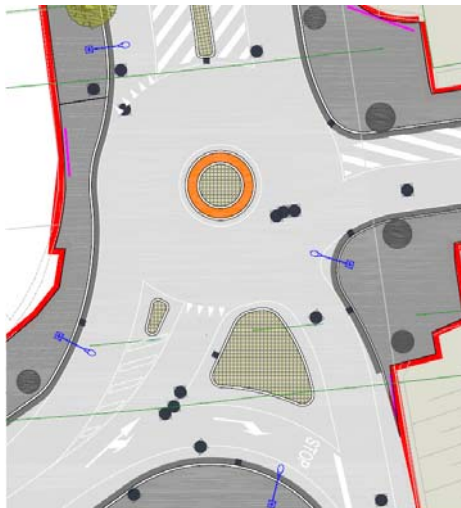
Figura 5.12 - Scenario di progetto- Corsia riservata svolta a destra su via Del Pascone
