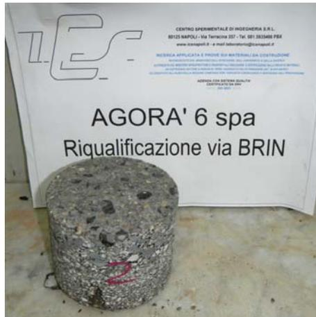
Figura 3.4 - Spessore conglomerato bituminoso – Sondaggio effettuato sede stradale su via Brin
