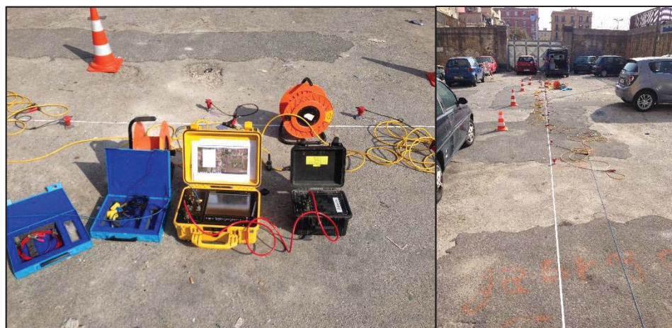
Foto 13: Strumentazione utilizzata e vista del profilo sismico MASW 1
