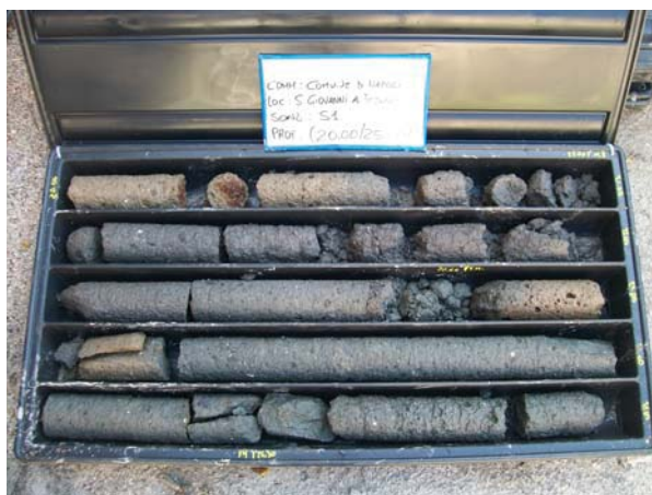
Foto3: Un esempio di campionamento in cassetta
