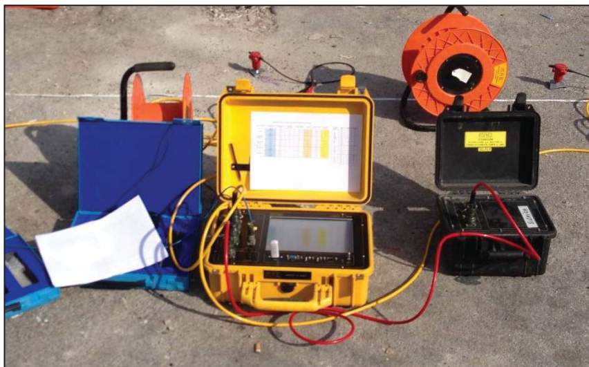
Foto 14: Sismografo A600S utilizzato per l'acquisizione dei dati
