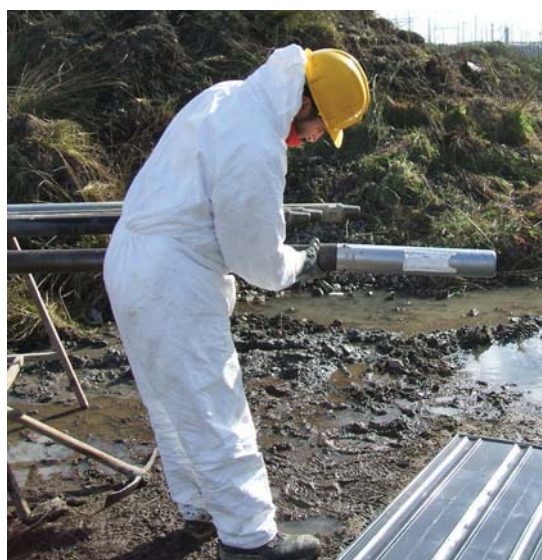
Foto 8: Il prelievo di un campione indisturbato,
