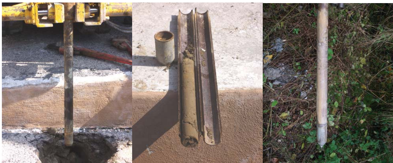
Foto 5-6-7: Il campionatore Raymond prima e dopo una prova S.P.T. , e con la punta chiusa
