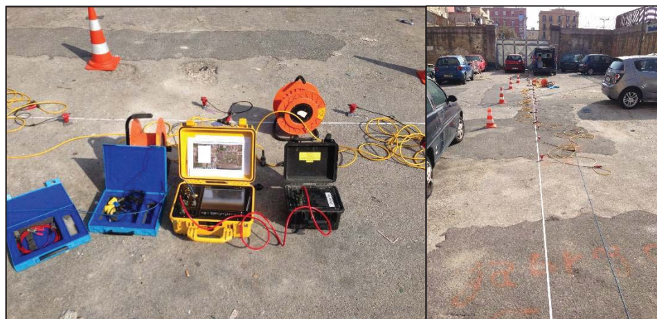
Foto 12: Strumentazione utilizzata e vista del profilo sismico MASW 1
