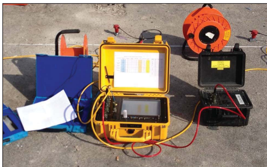
Foto 15: Sismografo A600S utilizzato per l'acquisizione dei dati
