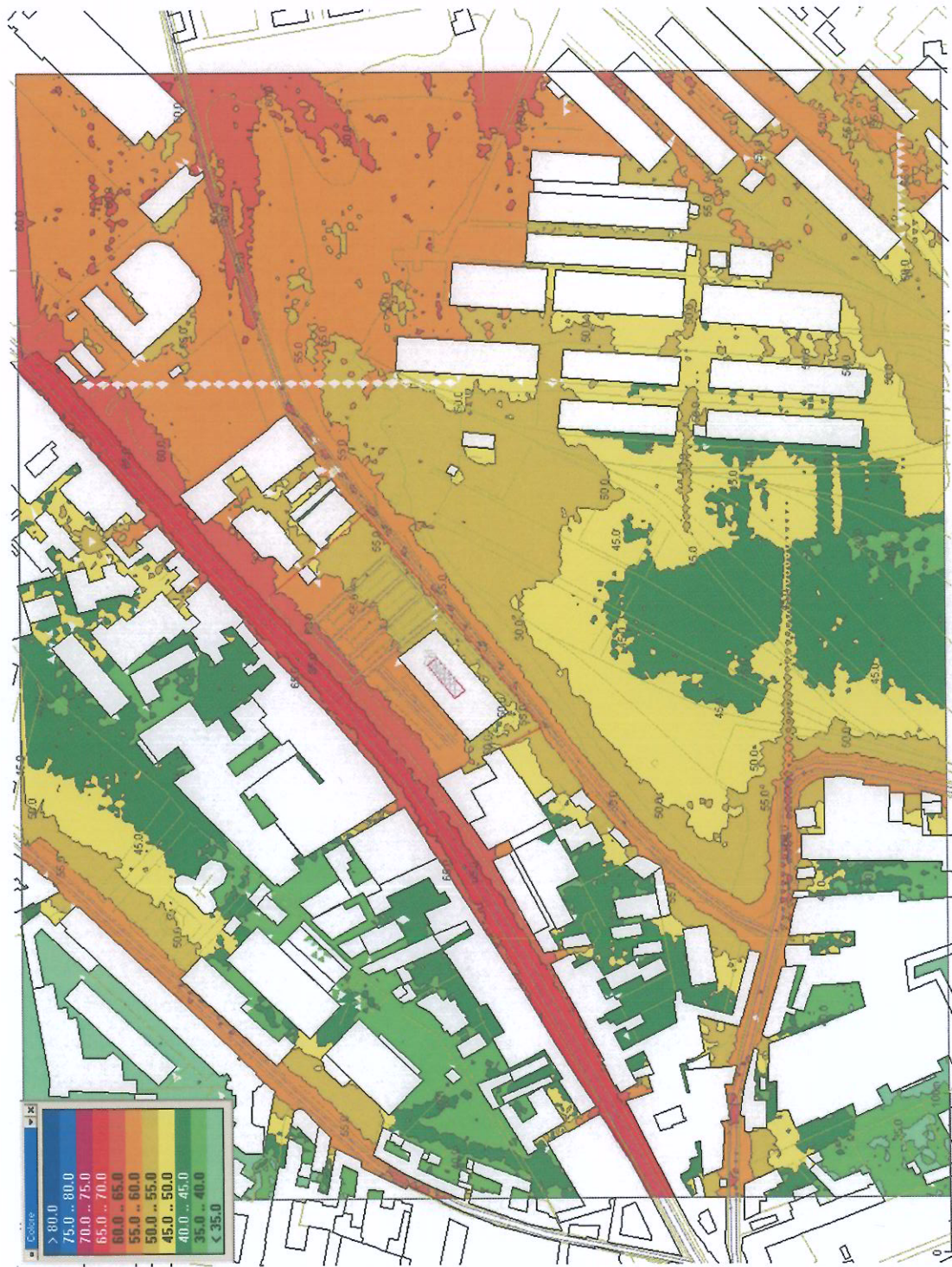
Tav. 13 : Clima acustico post operam diurno (6-22) a 4 metri calcolato con il software di simulazione Mithra.
