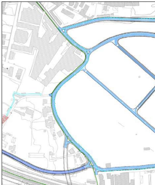
Figura 2.3 - Via Botteghele individuazione sottoservizi Wind (linea verde)
