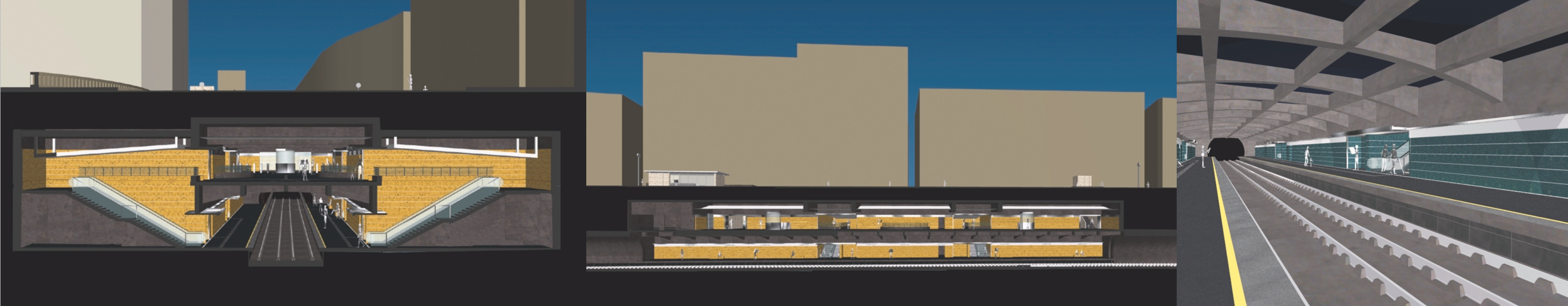
▲ Da sinistra a destra: due sezioni della stazione dell'Arco Mirelli e una sezione prospettica della stazione di San Pasquale a Chiaia della linea metropolitana 6
