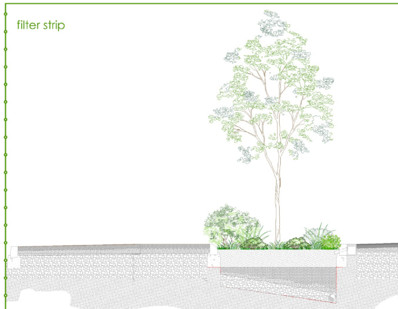
Figura 5.15 - Particolare filter strip
