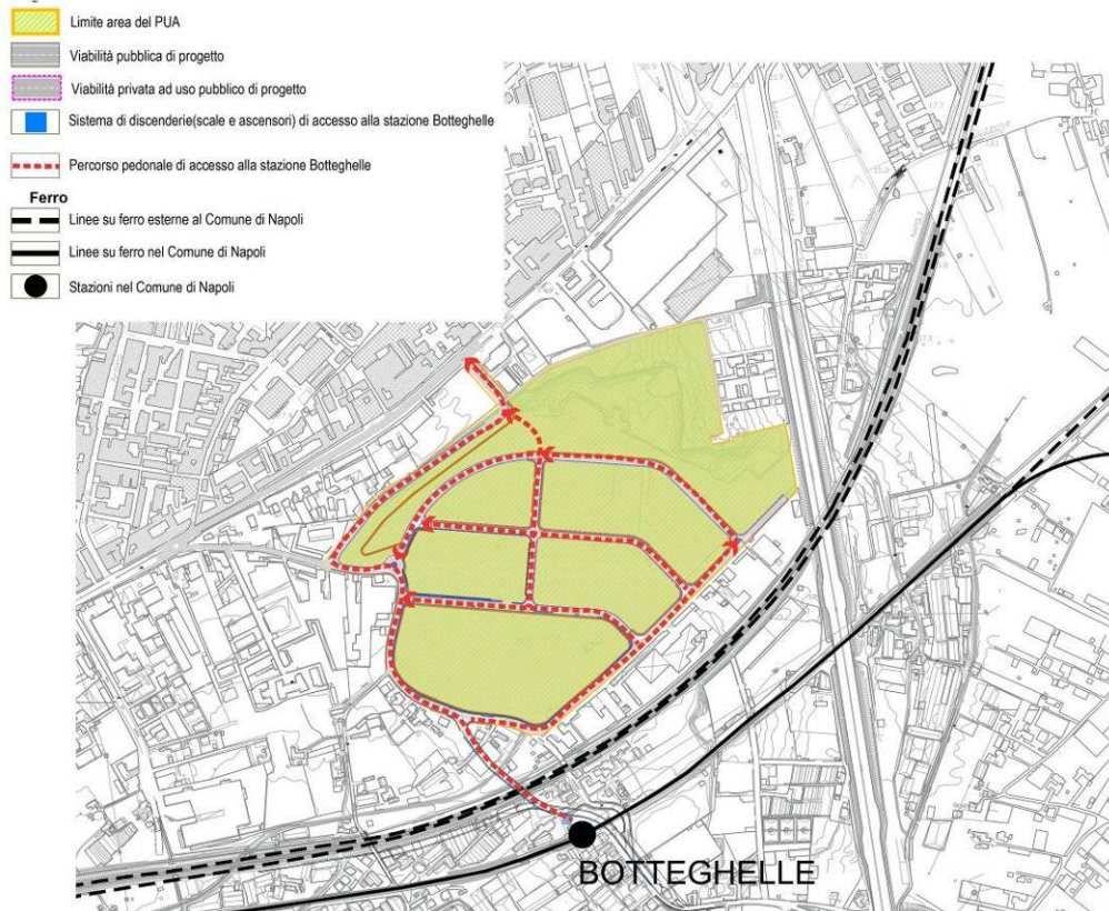
Figura 1.10 - Accessibilità pedonale alla stazione di Botteghele - percorsi pedonali dalla Stazione Botteghele all'area di intervento Il tema dell'accessibilità pedonale al trasporto pubblico è stato ulteriormente approfondito anche in merito al trasporto su gomma; la variante al PUA approvato prevede una nuova configurazione delle fermate in grado di garantire una buona accessibilità alla nuova linea TPS di progetto e nel contempo consentire un'adeguata accessibilità alle linee ANM che attualmente percorrono via Nazionale delle Puglie.
