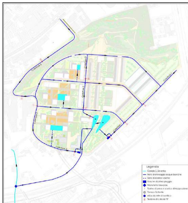
Figura 1.6 - Rete di drenaggio fognatura bianca
