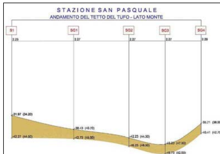
Figura 5.2.: Andamento del tetto del Tufo (lato monte) - Stralcio da Elaborato grafico Progetto Definitivo Stazione S.Pasquale allegato alla Relazione Geologica (cod. doc.:LM67F2C0158 – ANNO 2005).
