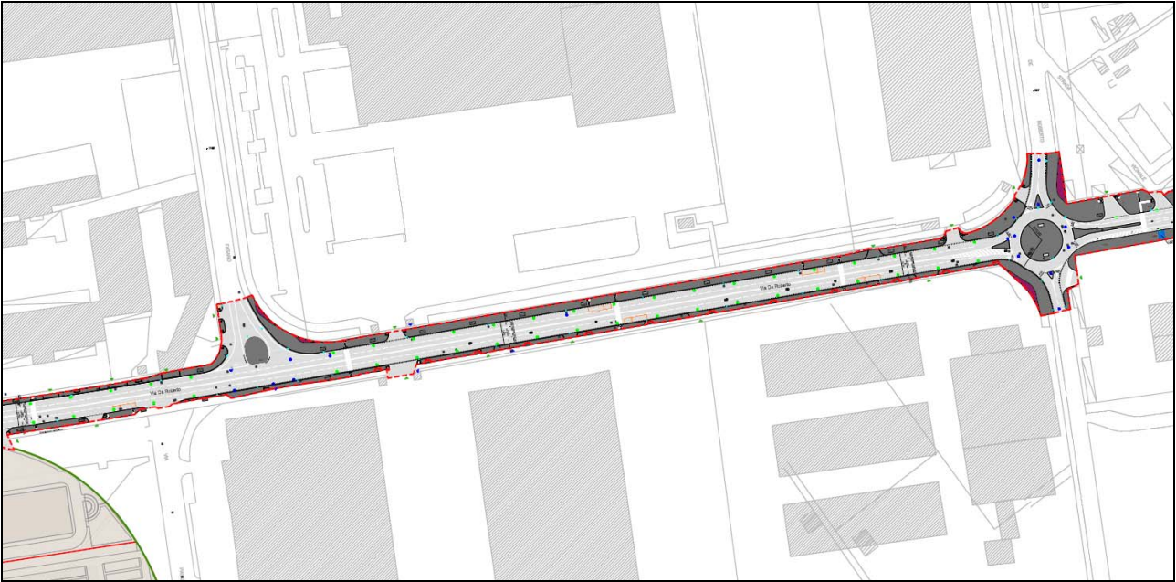
Figura 3.8 - Riconfigurazione dell'intersezioni tra via De Roberto e via Fasano e via De Roberto e Strada Vicinale Galeoncello
