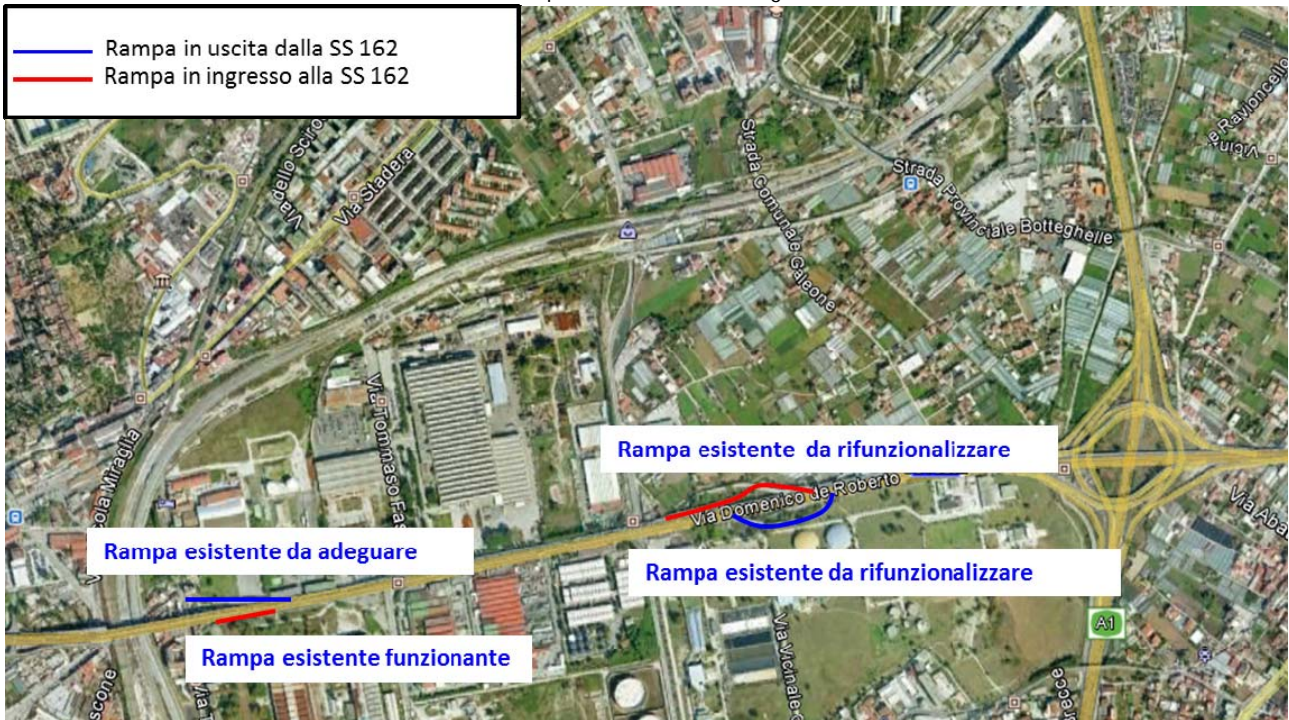
Figura 3.12 - Scenario di progetto- Rampe di collegamento tra via De Roberto e la SS162
