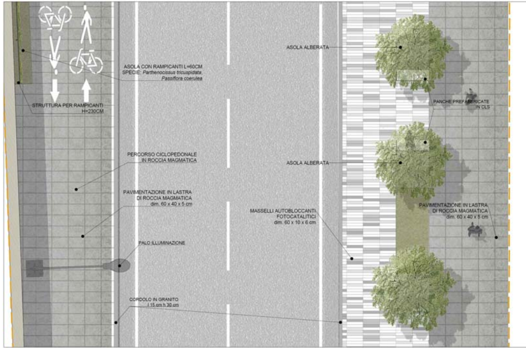
Figura 3.21 -Pavimentazione Marciapiedi via Imparato
