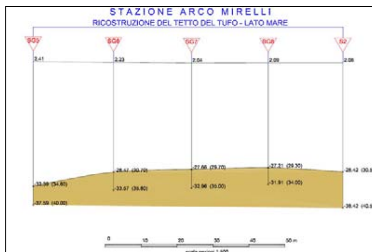
Figura 5.3.: Andamento del tetto del Tufo (lato mare) - Stralcio da Elaborato grafico Progetto Definitivo Stazione Arco Mirelli allegato alla Relazione Geologica (cod. doc.: LM67F2C0157 – ANNO 2005).
