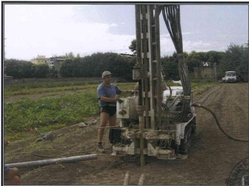
**FOTO N. 5 – Sondaggio n. 2 – Prova SPT**
